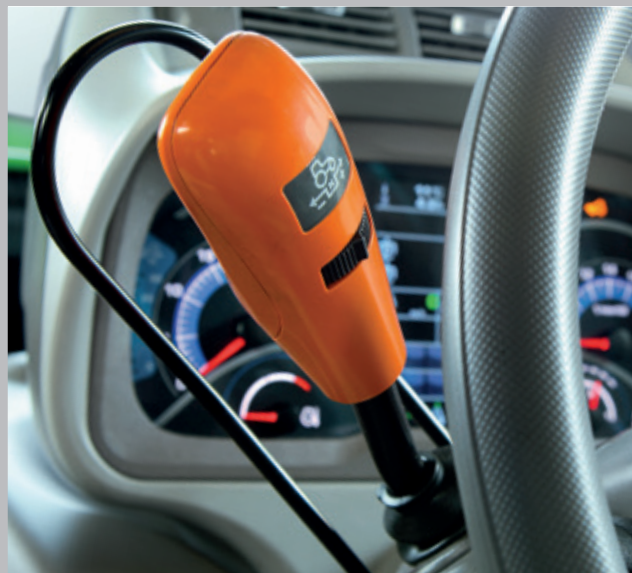
PowerShuttle ar SenseShift – 5 viegli pielāgojami atpakaļgaitas jutīguma līmeņi.
