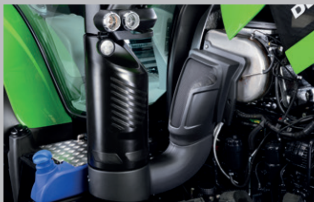
SCR sistēma un pasīvais DPF (dīzeļdegvielas daļiņu filtrs) degvielas un ekspluatācijas izmaksu samazināšanai.
