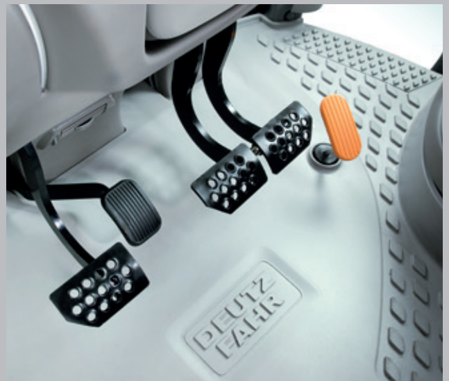
Booster bremžu sistēma nodrošina lielu bremzēšanas spēku ar mazu pedāļa spiedienu.
