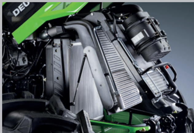
Uzlabota dzesēšanas sistēma. Pilnībā atverama apkopei.
